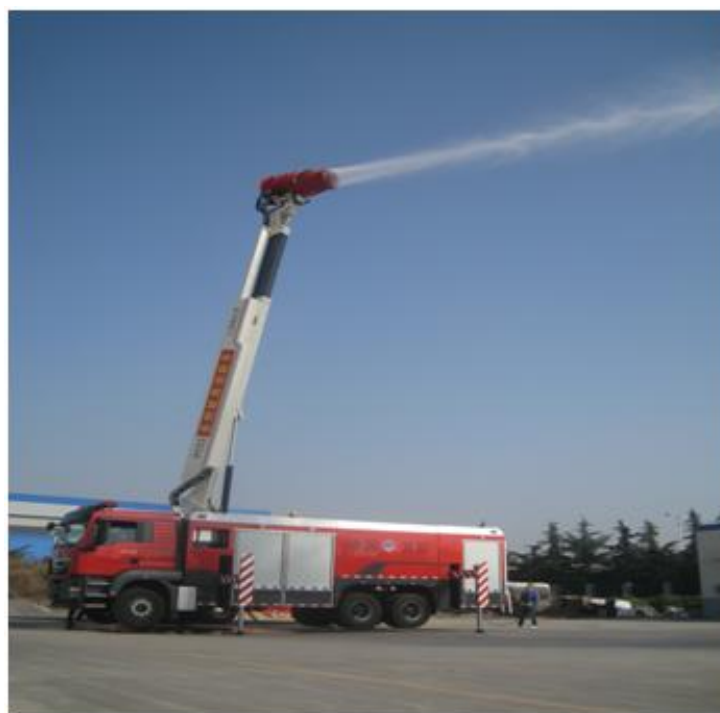
新研发的举高喷射多剂联用多功能消防车
