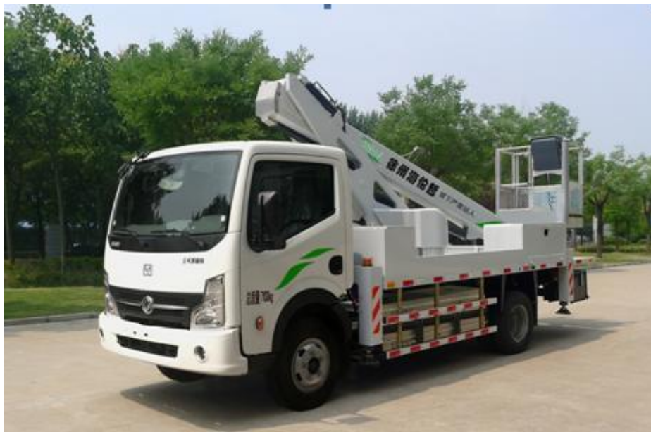
13米无支腿绝缘型高空作业车
