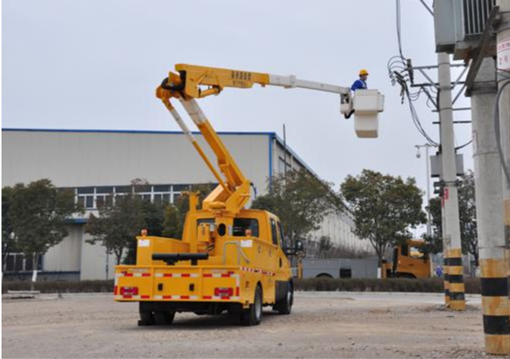
13米无支腿绝缘型高空作业车
