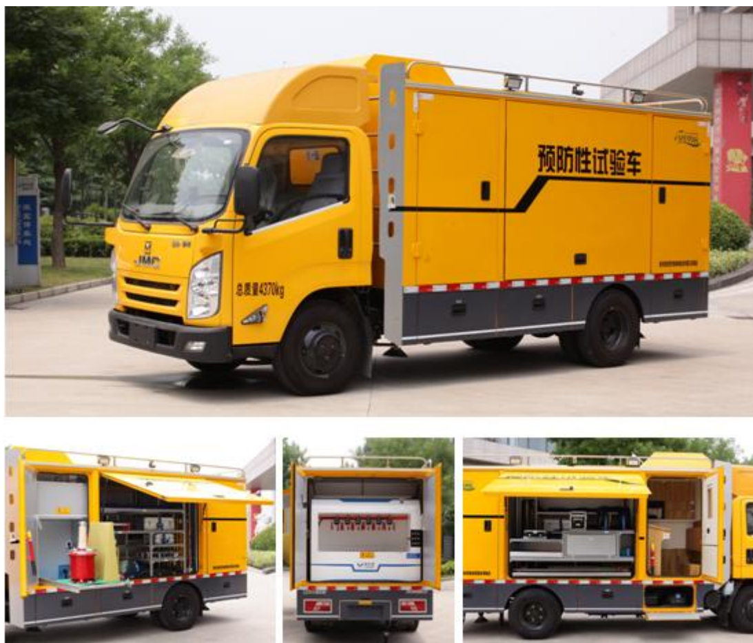
电力不停电作业装配预防性试验车
